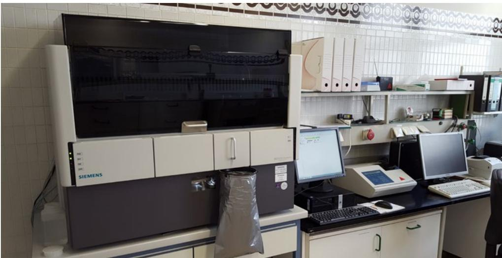
Analyseautomat BEP 2000 der Firma Siemens für die automatisierte Bearbeitung u. a. des QuantiFERON®-TB Gold Plus (QFT®-Plus)
