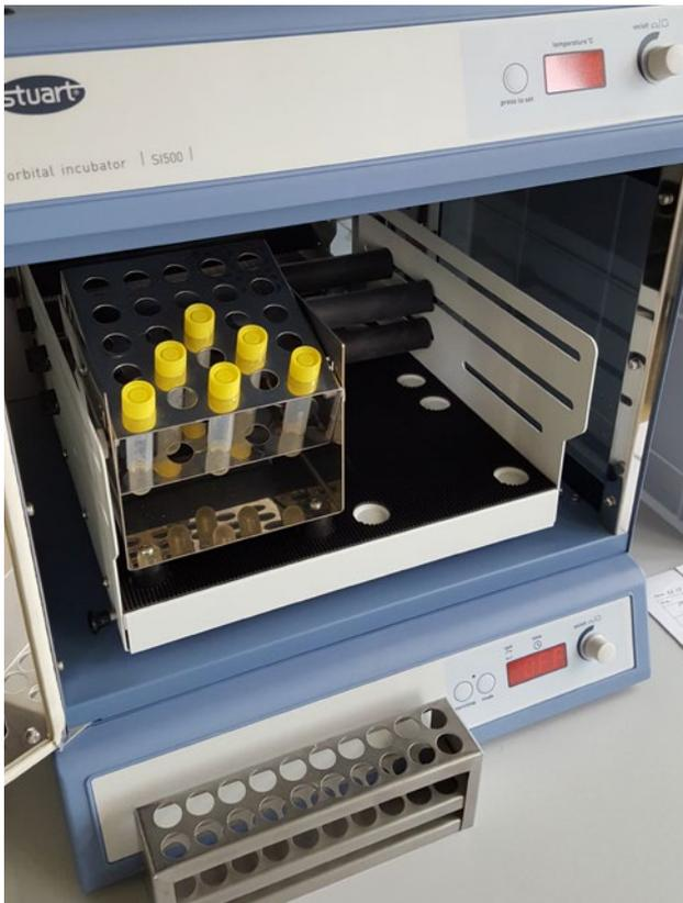
Abb. 40: Schüttelinkubator für die EHEC-Anreicherung
