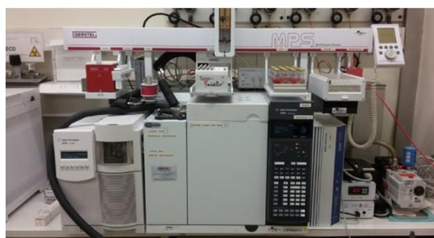
Abb. 16: GC/MS-Gerät zur Aromastoffanalytik
