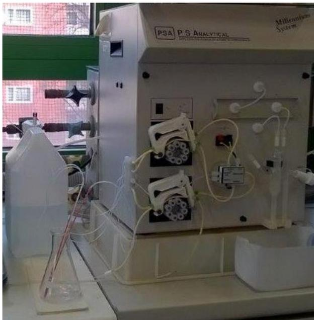
**Abb. 8:** Quecksilbermessgerät mit (Atomic Fluorescence Spectrometry) AFS Detektion
