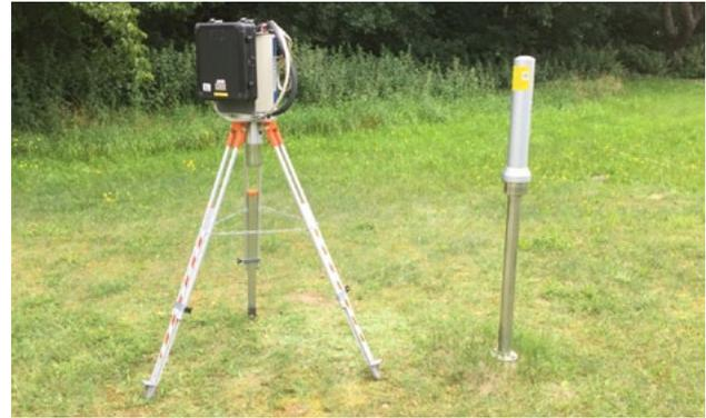
**Abb. 45:** Messbereites In-situ-Gammaspektrometer bei einer Vergleichsmessung
