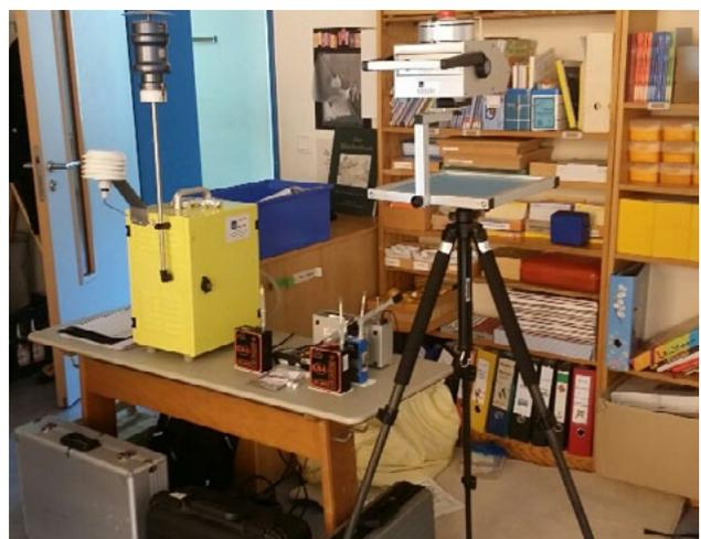
**Abb. 53:** Messaufbau zur Bestimmung von Parametern der Innenraumlufthausqualität in Berliner Schulklassenräumen
