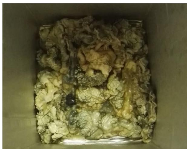
**Abb. 23:** Hochgradige Bildung von Schimmelpilzstrukturen am Boden der Verpackung
