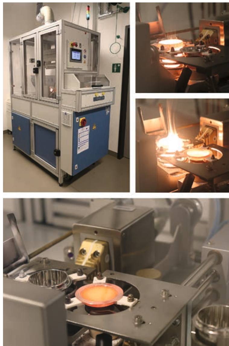
Abb. 4.11: links oben: Schmelzofen; von rechts oben nach unten: Herstellung eines Schmelzlings durch Aufschmelzen der Probe, Ausgießen in eine vorgeheizte Ausgießschale sowie Abkühlen bis hin zum glasigen Zustand mit einem definierten Heizpfad bei 1.050 °C für ca. 10 Minuten und am Ende für wenige Sekunden bei 1.200 °C geschmolzen
