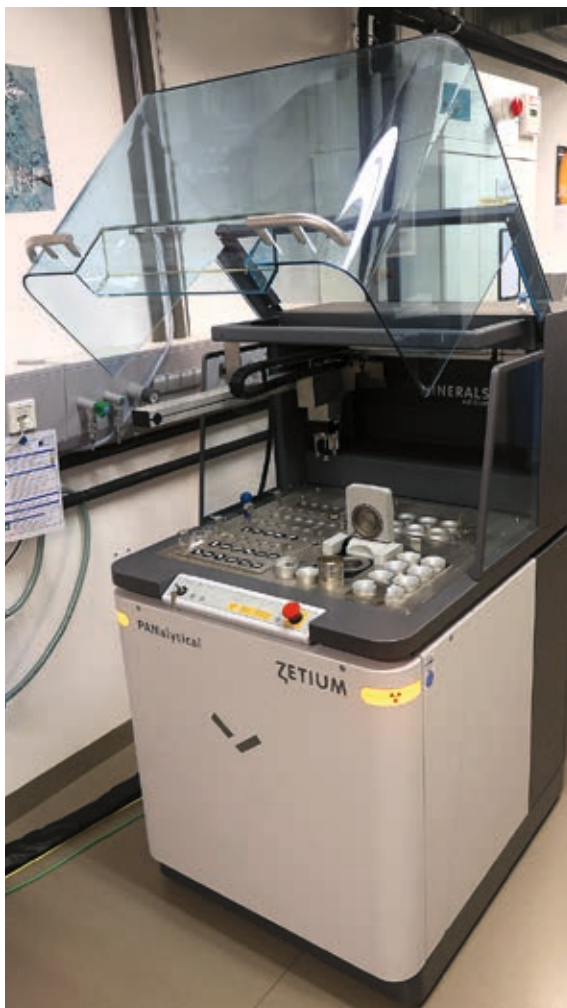
Abb. 4.13: Röntgenfluoreszenzgerät Malvern Panalytical Zetium zur Bestimmung der (geo)chemischen Zusammensetzung von Feststoffen
