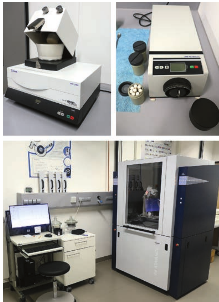
Abb. 4.14: links oben: Mörsermühle zur Vorzerkleinerung; rechts oben: Mikronisiermühle zur Feinzerkleinerung; unten: Röntgenpulverdiffraktometer (XRD) Bruker D8 Advance zur Bestimmung der mineralogischen Zusammensetzung von Feststoffen
