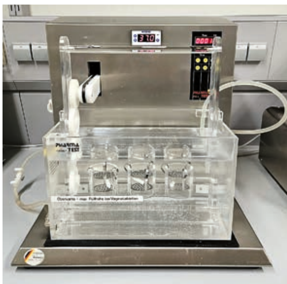
Abb. 1.17: Apparatur zur Prüfung der Zerfallszeit fester Arzneiformen zur rektalen oder vaginalen Anwendung
