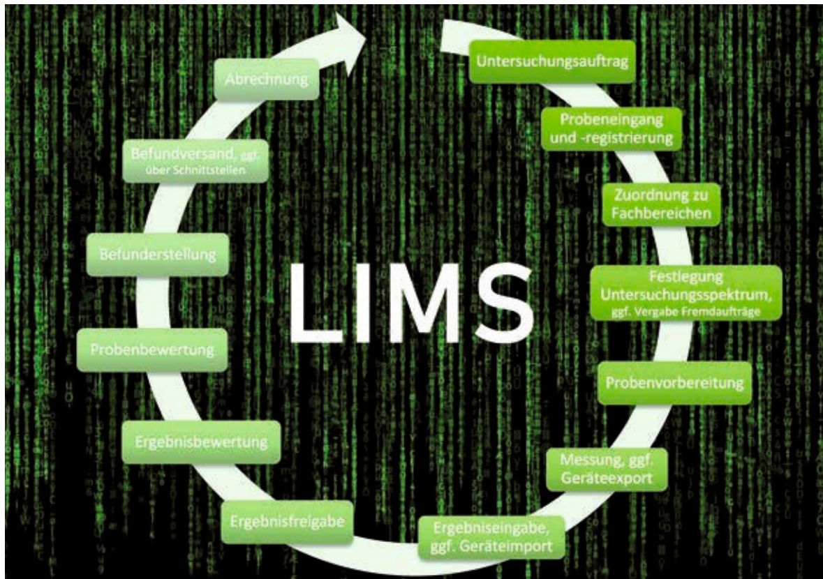
Abb. 0.1: Schematische Darstellung eines Probendurchlaufs mit einer Auswahl an Schritten, die von einem Labor-Informations-Management-System (LIMS) zu unterstützen sind
