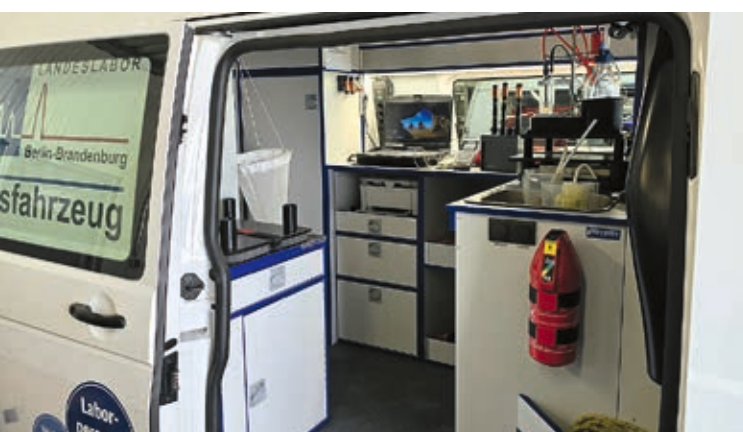
Abb. 4.4: Die speziell ausgestatteten Messfahrzeuge sind „mobile Labore“ für Umweltprobenahmen.
