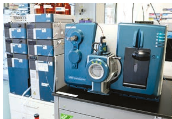
Abb. 2.5: LC-PDA-MS/MS-System, das u. a. zur Untersuchung von gebeiztem Saatgut, das hohe Gehalte an Pflanzenschutzmittelwirkstoffen enthält, verwendet wird
