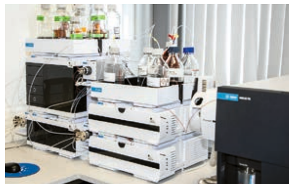
Abb. 4.2: Zur Bestimmung organischer Verbindungen werden die Proben nach der Aufbereitung (i. d. R. zwei Tage) im LC-MS/MS gemessen
