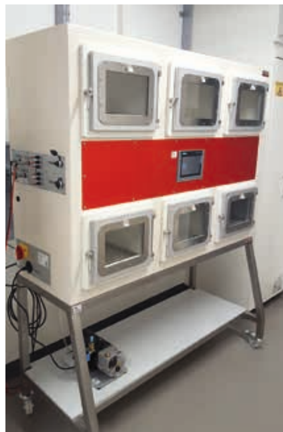
Abb. 3.2: 6-Kammer-Inkubator zur Anzucht, beispielsweise von Keimen der Gattung Campylobakter und Yersinia
