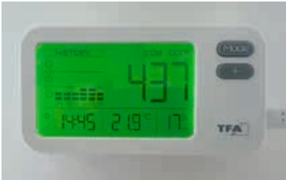
Abb. 4.10: CO 2 -Messgerät mit Anzeige des Messwerts und einem Display-Ampelsystem in einem Pausenraum des LLBB zur Unterstützung des Lüftungsverhaltens
