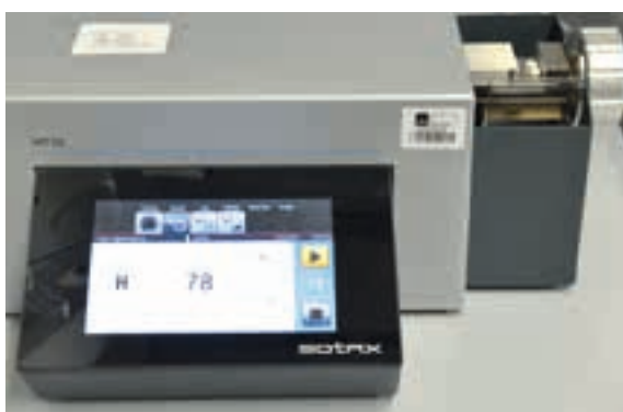
Abb. 1.27: Tablettenhärte-Testsystem nach einer Messung. Für die Bruchfestigkeitsprüfung werden die zwei gegenüberstehenden flachen Backen unter definierten Bedingungen gegeneinander bewegt und die einwirkende Kraft – ausgedrückt in Newton (N) – im Zeitpunkt des Zerbrechens der Tablette gemessen.
