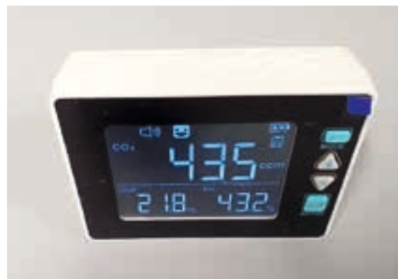
Abb. 4.6: CO 2 -Messgerät EMAQ 32 der Firma Electro-Mation
